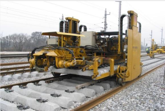
Zwischenlagern der Schwellen - Transportieren und Verlegen durch zweite optionale Einheit
