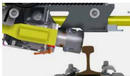
Maximaler Schwenkbereich 32° außen und 80° innen
