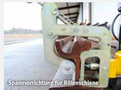
Spannvorrichtung für Rillenschiene
